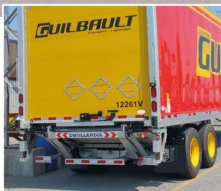
La DH-RM.25 se suele montar bajo una placa de extensión para cama reforzada con **2 robustos paragolpes** y escalera ajustable. Pero también puede montarse enrasada a la estribera trasera de la carrocería del vehículo. Esta plataforma, al poderse guardar replegada, es ideal para trabajos **que requieren un acceso frecuente a los muelles de carga**. El paragolpes opcional OAF105 es compatible con los **sistemas de sujeción y bloqueo (DOCK-LOCK)**.
