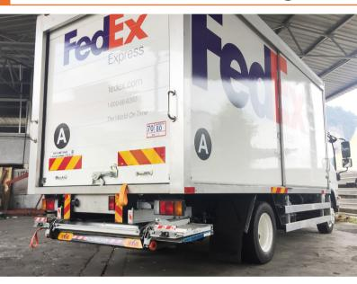
Las plataformas retráctiles DH-SO... están equipadas con un **plato de doble plegado** que descansa sobre los brazos de elevación cuando la plataforma se guarda en su posición de descanso. Esta construcción compacta permite la instalación de estas plataformas en vehículos con un voladizo muy corto.
