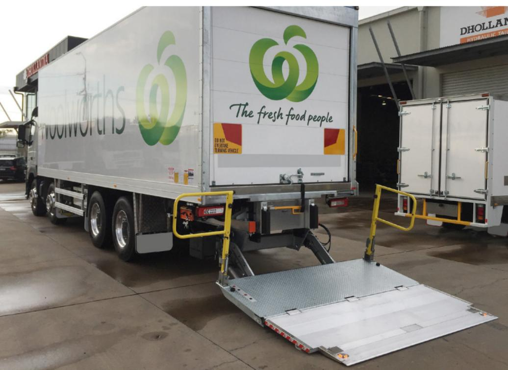
La DH-SM(R).20 es la **más vendida del rango de plataformas retráctiles de capacidad media**. Esta versátil plataforma es capaz de manejar varios tipos de carga, incluyendo palets, hasta un max. de 2000 kg.
