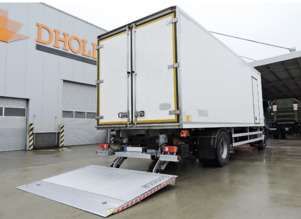
La DH-LM.20 es una **plataforma de capacidad media extremadamente versátil**, apropiada para camiones comerciales de más de 7,5T, remolques y semi-remolques.
